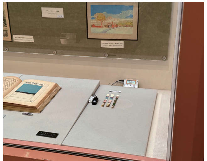
図 3. データロガー及び試料の設置の様子
