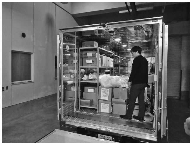
移動式燻蒸車での燻蒸（資料搬入後の様子）
