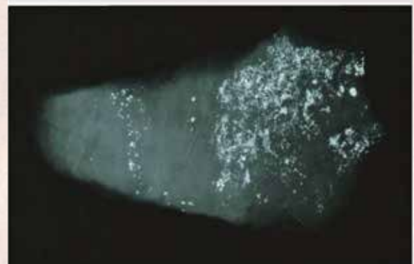
図3 母岩表面に見える赤い部分が辰砂（上）。エックス線写真では、辰砂は白い点として見える。上の写真では赤色が見られない部分にも辰砂があることが確認できた（下）。
