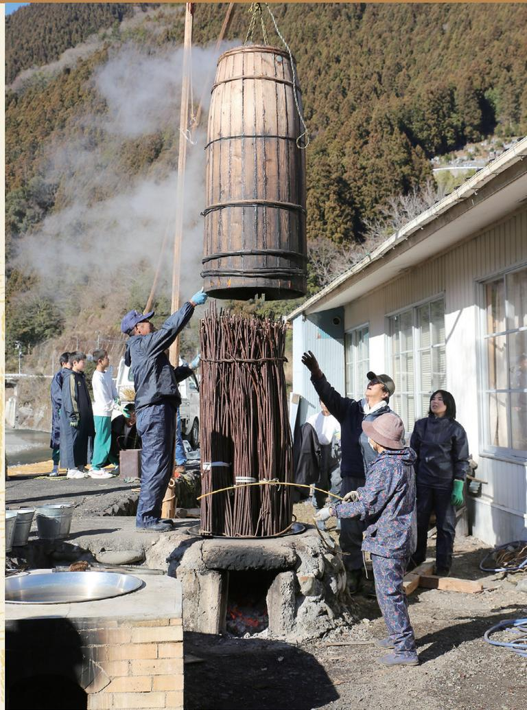
図2 阿波太布製造技法保存伝承会によるカジ蒸しの作業
