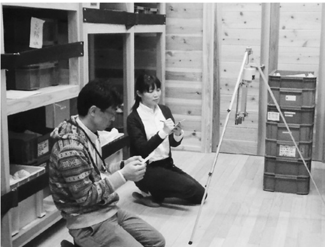
アスマン式通風乾湿計による温湿度計測
