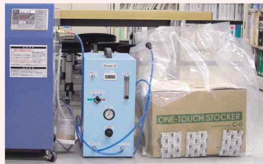
図2 窒素発生装置（中央の水色のもの）を使って箱に入った資料の殺虫処理をしている様子
