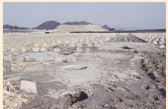
図3 阪神淡路大震災の時に生じた噴砂(鳴門市里浦)。この時の噴水は高さ2mにも達したとのこと。(1995年1月20日撮影)
