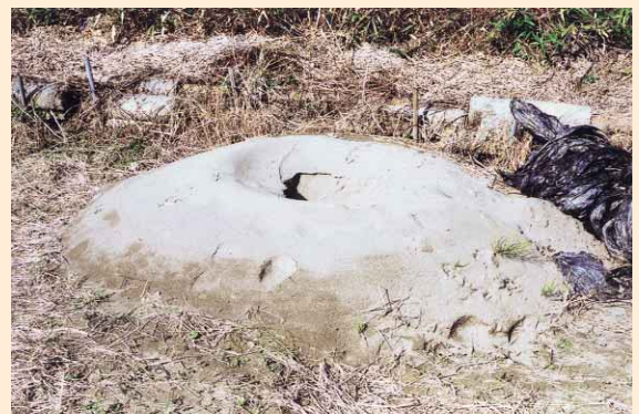
図2 図1の右手前の噴砂のクローズアップ。
