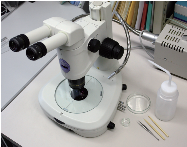
図2 顕微鏡と解剖用の道具（ピンセット，柄付き針，シャーレ，アルコール）。
