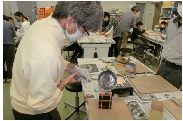
銅鐸の鑄型に溶けた金属を流し込む
