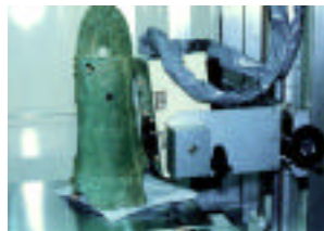
大型試料室を備えた蛍光X線分析装置 移動する検出部でさまざまな部分の測
