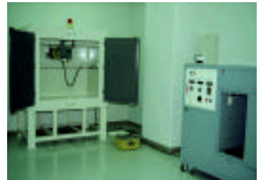
X線透過撮影装置 左：工業用X線透過撮影装置 右：ソフトX線透過撮影装置
